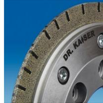
La combinaison d'un bandeau à diamants imprégnés avec des barrettes de diamant CVD (RI-GC) ouvre de nouvelles perspectives en matière de dressage : l'usure du dresseur est limitée par le renforcement des arêtes, sans nuire à sa capacité de coupe. Comme ces molettes se caractérisent par une très bonne stabilité des bords, ils permettent la production de profils délicats et très précis.
