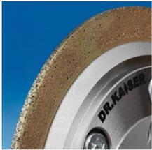
Les molettes frittées avec couche infiltrée (RI) peuvent être adaptées à la meule à dresser en adaptant la spécification des diamants, leur concentration, la largeur du bandeau, les propriétés et la porosité du liant. Elles sont très stables et peuvent être fabriquées jusqu'à une largeur minimale de bandeau de 0,6 mm, sans support de revêtement ; ce qui rend également possible le dressage de profils.
