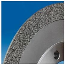
Les molettes à revêtement galvanique positif (RIG) monocouche, dans un liant de nickel dur, sont robustes et performantes. Leur comportement au processus de dressage peut être adapté en fonction des différents types et tailles de diamants utilisés et leur taux d'enrobage dans le liant. Le support de couche, qui peut être en acier ou en laiton, doit être usiné par la meule lors du dressage.
